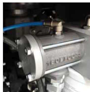
Válvula de mínima presión Construida en nuestra Empresa con materiales inoxidables, una elección técnica inteligente para garantizar la máxima fiabilidad en cualquier condición de trabajo.
