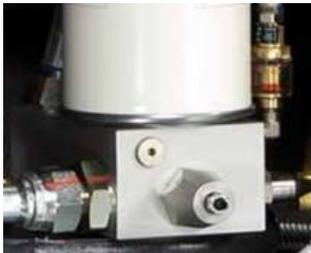
**VALVULA DE MINIMA PRESION** Realizada en materiales resistentes a la oxidación, esta mecanizada de un solo bloque. Una cuidada atención en su construcción, para garantizar el funcionamiento aún en las condiciones más extremas
