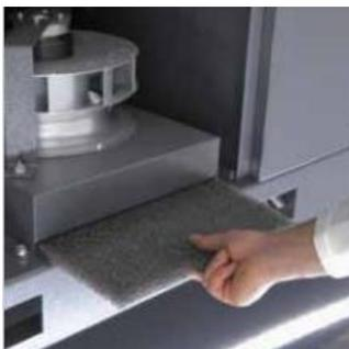
**PANELES DE PREFILTRACION DEL AIRE DE REFRIGERACION:** El panel de prefiltración, lavable y estándar en todos los modelos, ayuda a mantener limpio el interior de la máquina y garantiza la facilidad de mantenimiento
