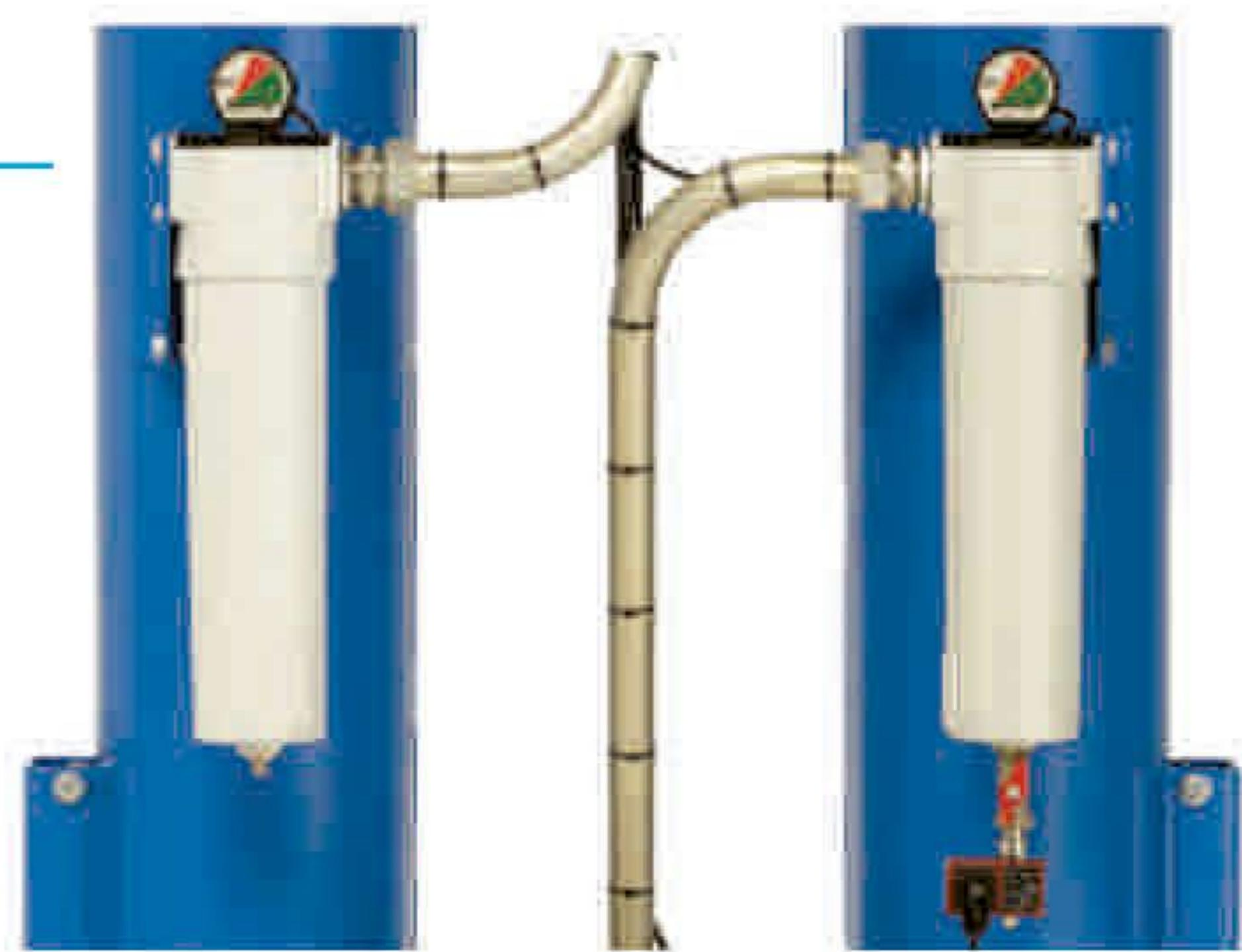
Los secadores están equipados con un filtro separador de aceite de 0,01 micrones de entrada (con descargador automático) y un filtro antipolvo de 1 micrón de salida. Ambos cuentan con un manómetro diferencial, se puede acceder fácilmente a ellos para mantenimiento y se incluyen en las dimensiones del secador.
